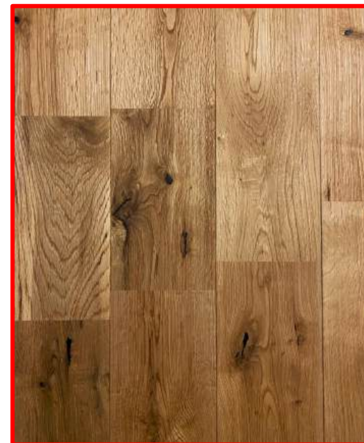
節・パテ補修が多い
